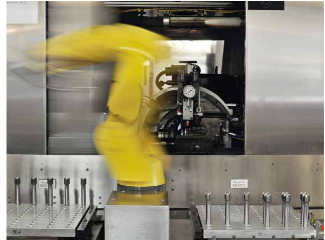
Abb. 8: Robotergestützte Beschickung einer Werkzeugmaschine
