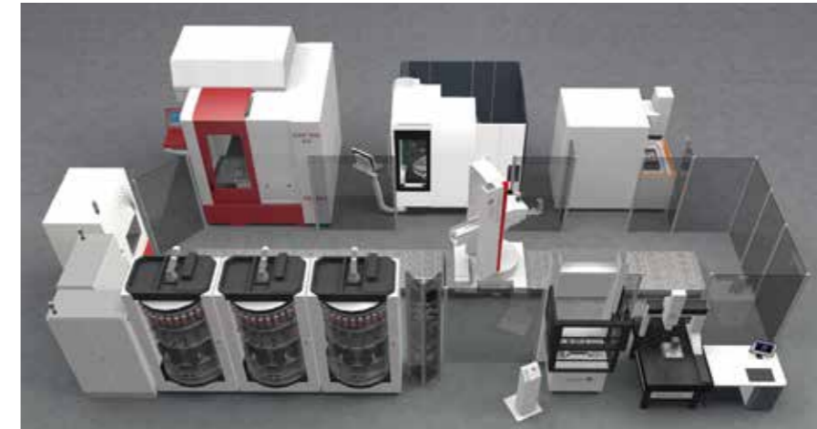
Abb. 10: Verfahrensgemischte automatisierte Werkzeugfertigung
