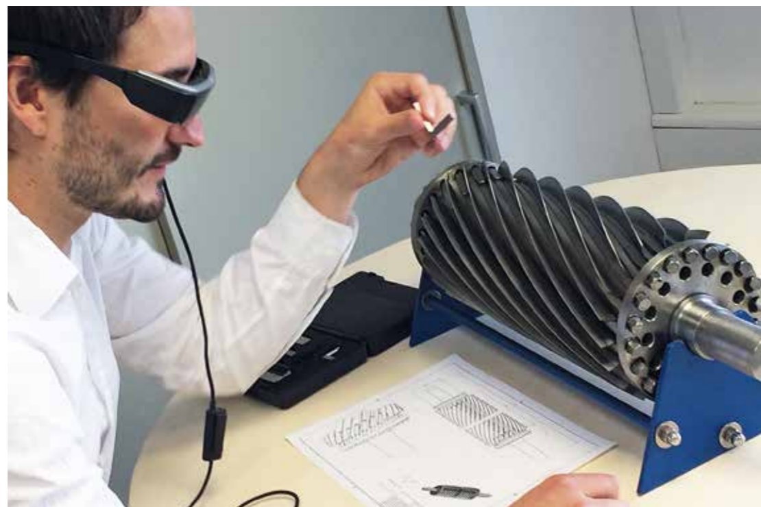
Abb. 2: Einsatz einer Datenbrille im Herstellungsprozess
